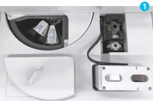
An Bord ist Kapazität für bis zu fünf Reagenzien-Sets, deren Reagenzinformationen über den Barcode auf dem Behälter verwaltet werden. Das automatische Öffnen und Schließen der Reagenzienbehälter sorgt für eine längere Haltbarkeit, die Reagenzien werden regelmäßig automatisch durchmischt.
