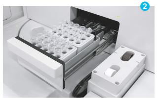
Die speziellen Messküvetten, die im CLEIA\*-Modul verwendet werden, können unkompliziert ersetzt werden, indem das gesamte Tray ausgetauscht wird.
