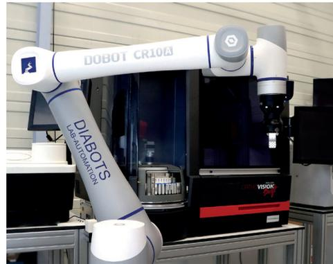
In Kombination mit modularen Roboterlösungen für die Probenzufuhr der Firma Diabots können immunhämatologische Proben zeitweise völlig personalunabhängig abgearbeitet werden. Diese Lösungen sind bereits mehrfach in verschiedenen Laboren maßgeschneidert und individuell realisiert.
